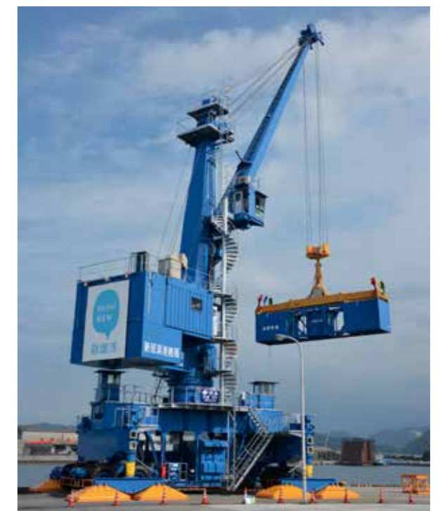
タイヤマウント式ジブクレーン(画像提供:新居浜港湾局)
