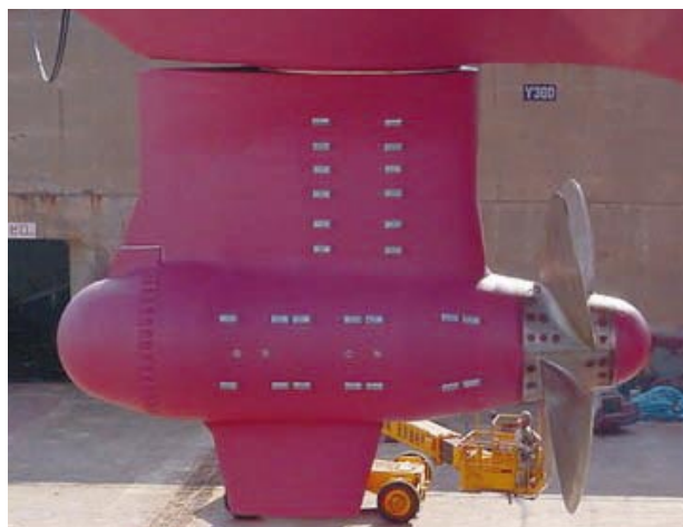
図5 電動ポッド型推進器 Azimuthing podded propulsion unit
