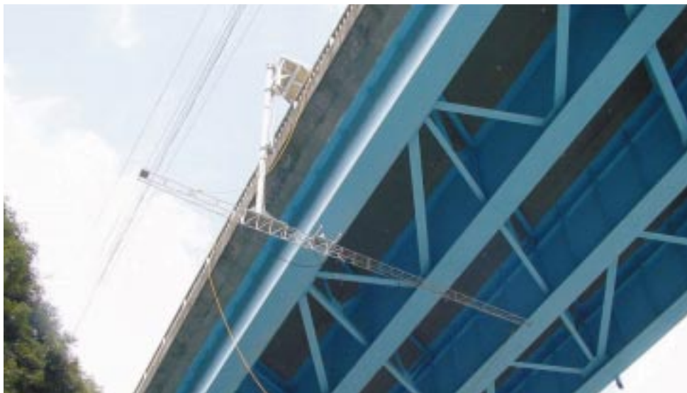
図1 桁下診断システム Under-deck inspection system
