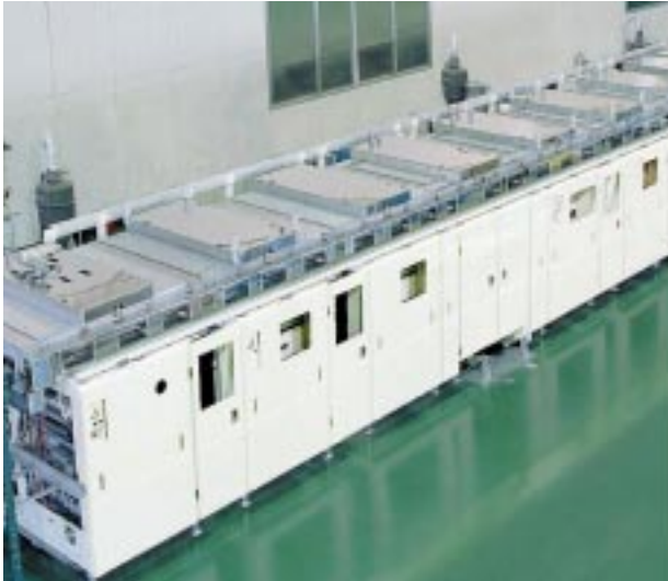
図1 成膜装置 Plasma coating system
