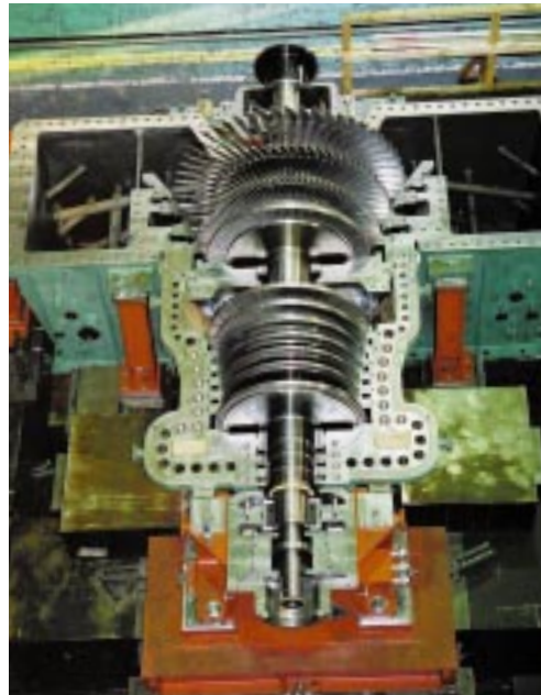
図1 34MW 蒸気タービン 34MW steam turbine
