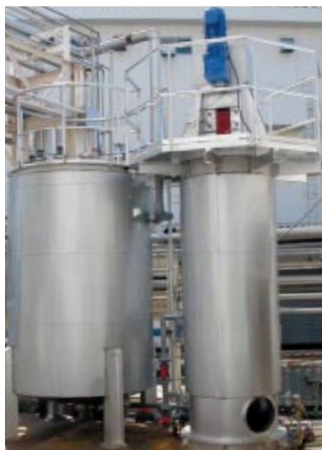
汚泥可溶化装置パイロットプラント Excess sludge dissolving system (Pilot plant)
