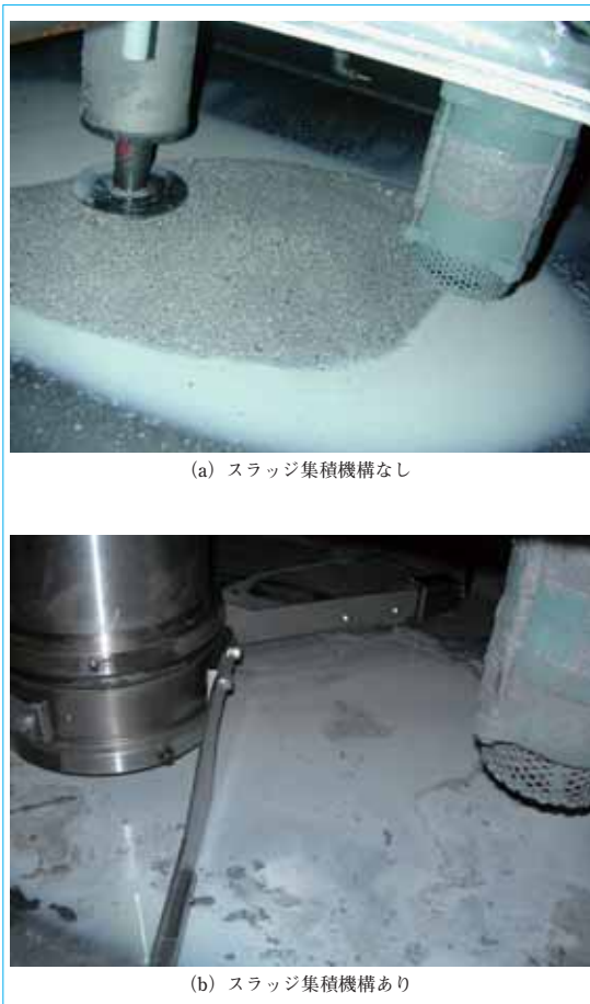
図2 スラッジ集積機構の効果 Effect of sludge accumulation system
