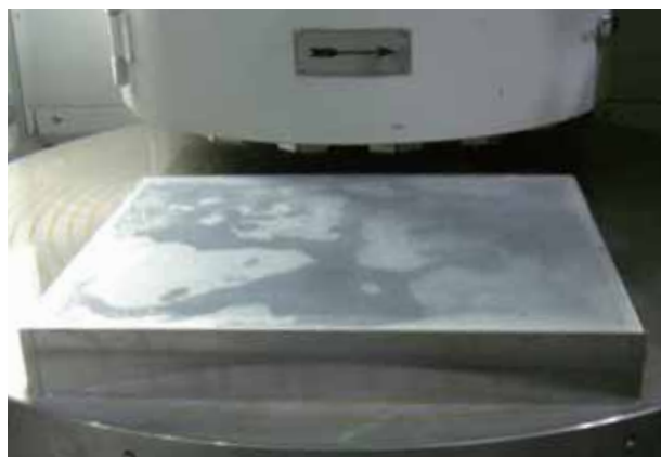
図2 研削加工後の石英ガラス Grinding results of fused silica
