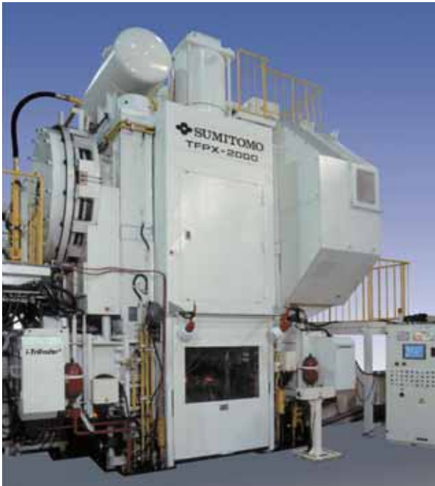
最新の制御方式によるi-Tr@ansfer TM およびi-H@nd TM を装備した20000 kN自動鍛造プレス 20000 kN automatic forging press with i-Tr@ansfer TM and i-H@nd TM
