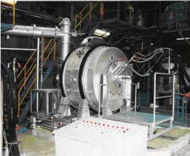
図3 バッチテスト用試験機（ロータリーファーネス） Bench scale test equipment (Rotary furnace)
