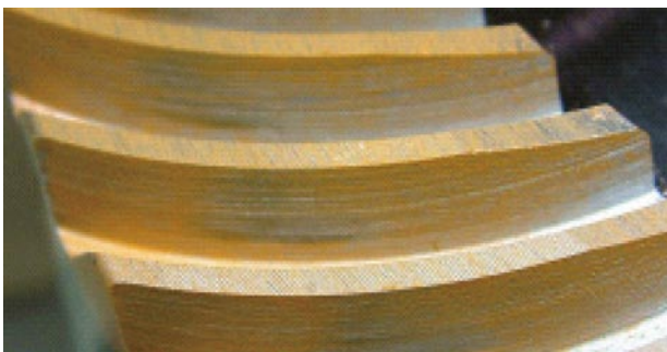
図9 グリーソン歯切り盤により歯切りされたギヤ歯面上の歯当たりマーク Tooth contact mark on tooth surface of gear generated by Gleason generator
