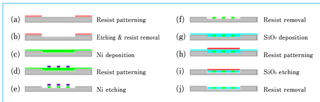
図1 マイクロヒータの製作プロセス Process flow of micro heater fabrication
