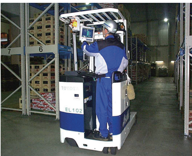
図6 ピッキングフォークリフトシステム Picking forklift system
