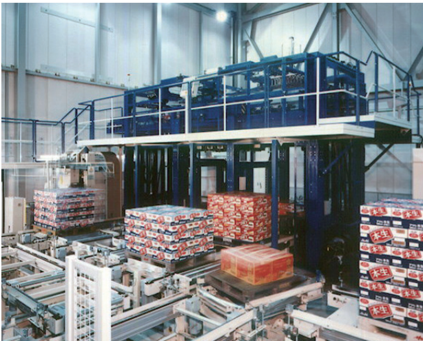
図5 層ピッカ(自動ケースピッキング装置) Automatic case picking system
