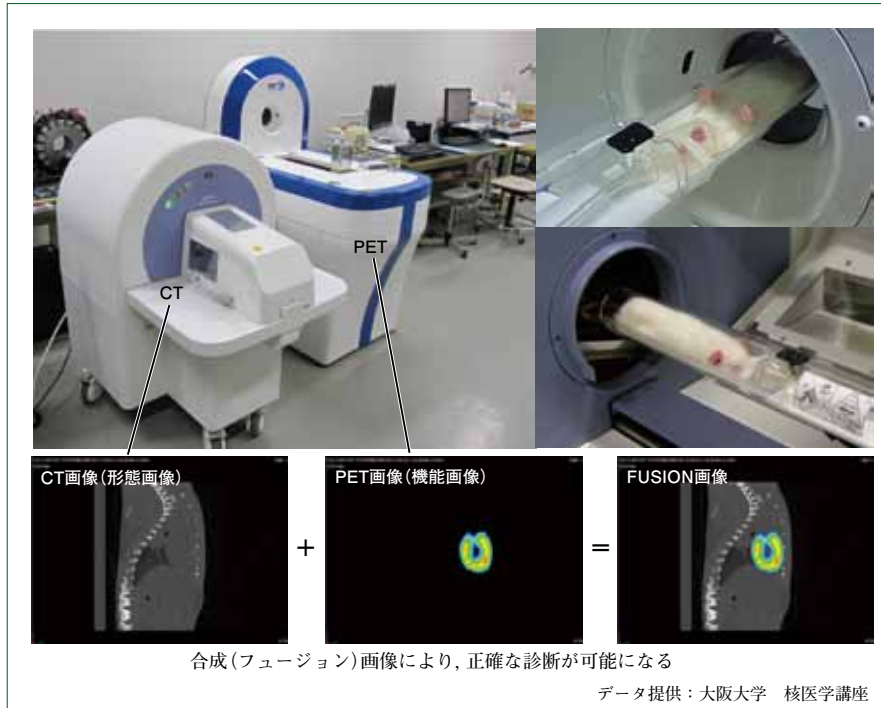
マルチモダリティ(PET・CT装置など)画像フュージョン Multimodality system (PET-CT etc.) and its image fusion.
