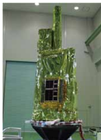
図3 フライトモデル 振動試験状況 Vibration test of flight model
