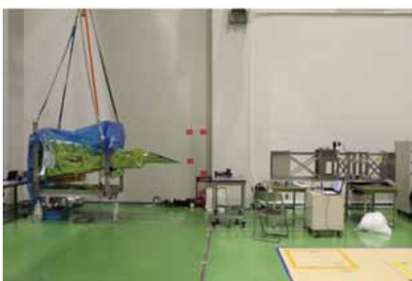
図5 フライトモデル 振動試験前後の光学アライメント試験状況 Optical alignment measurement before and after vibration test
