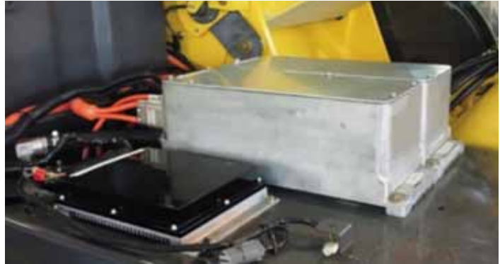
図5 インバータ・コンバータユニットおよびコントローラ Inverter/Converter unit and controller
