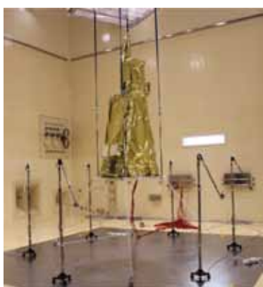
図4 フライトモデル 音響試験状況 Acoustic test of flight model
