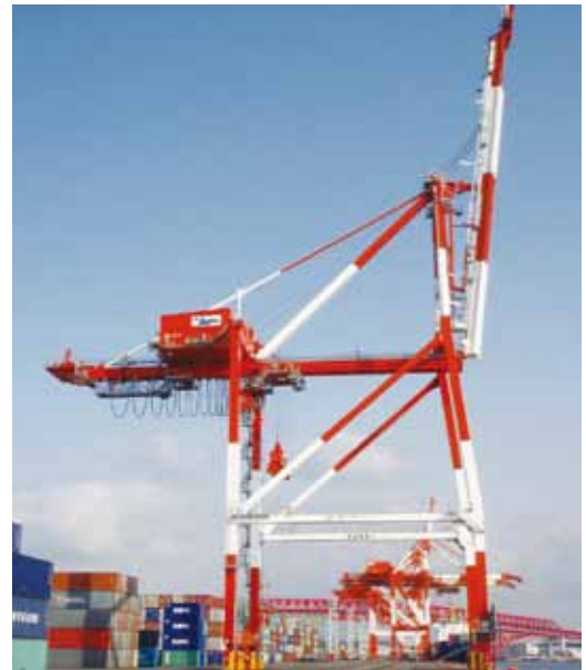
図9 コンテナクレーン(CC) Container crane
