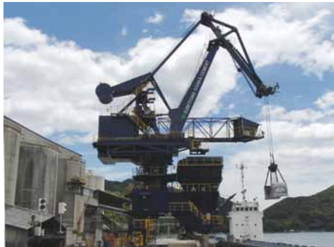
図11 ダブルリンク式水平引込みアンローダ Rail-mounted level luffing unloader
